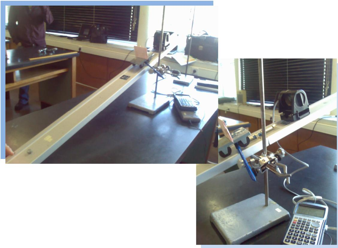
2. Marque na calha o ponto a partir do qual o corpo será largado. Meça a altura,  $h$ , desse ponto, relativamente à superfície horizontal da bancada.
